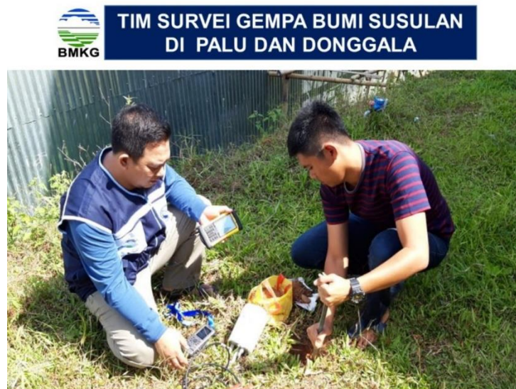
Gambar 2. Pemasangan sensor tambahan kerjasama BMKG dengan Earth Observatory of Singapore (EOS).
