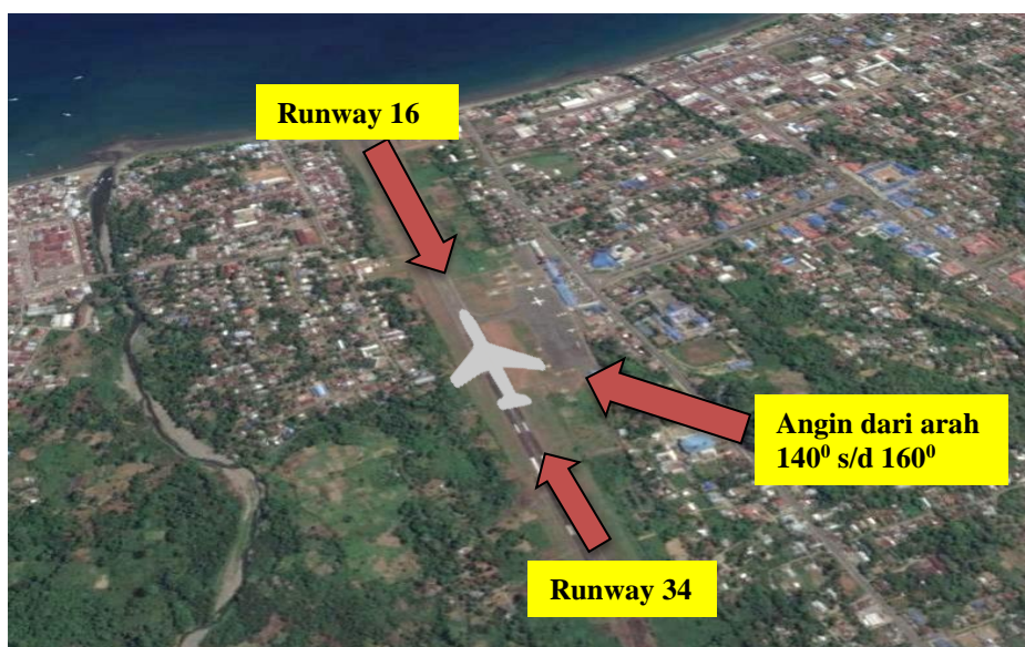
Gambar 1. Visualisasi Runway Landasan Pacu Bandar Udara Douw Aturure Nabire (Sumber : Nanda Rinaldy dkk, 2017)
